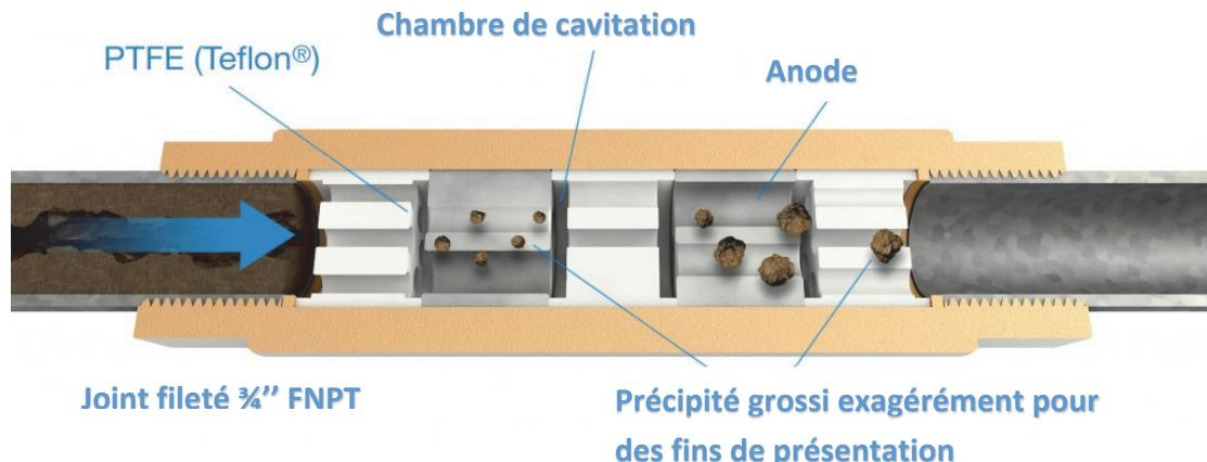
1- En circulant l'eau subit des changements de pression rapide créant de la cavitation ce qui fait se précipiter ou débuter une cristallisation (la nucléation) des ions calcaire. Ils sortent ainsi de l'eau et ne sont donc plus en solution dans l'eau mais en suspension (colloïde).
